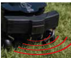
RADAR para detección de obstáculos
