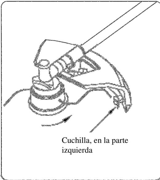
El cabezal de nylon gira en sentido contrario de las agujas del reloj. La cuchilla que regula la longitud del nylon debe de estar colocado en la parte izquierda del protector
