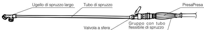
Dopo avere verificato la corretta installazione della guarnizione, applicare saldamente il tubo di spruzzo alla presa e l'ugello di spruzzo largo al tubo di spruzzo. Serrare quindi bene la vite accertandosi che non vi siano perdite d'acqua dalla guarnizione. Un serraggio eccessivo potrebbe causare l'estruzione o la rottura della guarnizione stessa. È importante mantenere la corretta pressione di chiusura.
