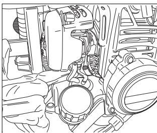
**2** Fermez entièrement le starter. (S'il fait chaud ou si le moteur de la machine est chaud, ouvrez légèrement ou complètement le starter.)
