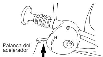
**4** Coloque la manija de la válvula reguladora de presión en "STARTING".
