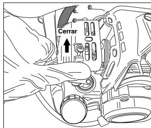
**3** Mueva la palanca del acelerador a la posición de velocidad media y baja.
