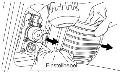
**2** Schultern Sie das Gerät, und drücken Sie von beiden Seiten auf den Hüftstabilisator.
