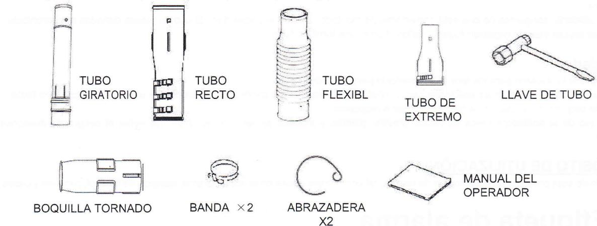
PASO 2) Con un destornillador de cabeza plana, use un BANDA para conectar el TUBO FLEXIBLE a la TUBO ACODADO. A continuación, utilizando una BANDA, conectar el TUBO GIRATORIO para el TUBO FLEXIBLE. Apriete con un destornillador. (vea el bosquejo).
