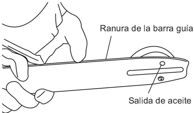
Para evitar fallos en el equipo, utilice una hoja de acero, etc. para eliminar la suciedad adherida alrededor de la salida del aceite, de la ranura de la barra guía y del ajustador de tensión después de terminar el trabajo diario.
