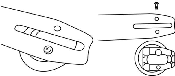
Para evitar un desgaste desigual, se debe instalar la barra guía boca abajo de manera ocasional.
